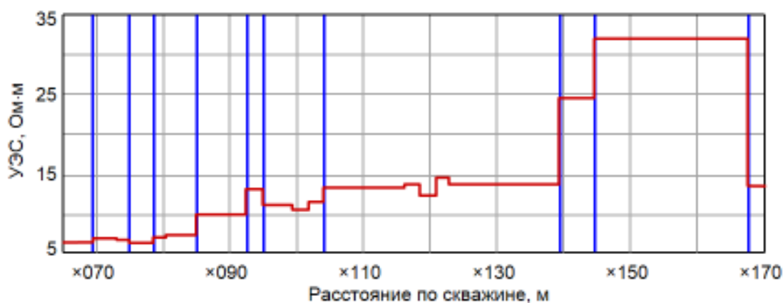
Рисунок 4.21 – Распределение УЭС вдоль скважины по данным \rho_k и результатам совместной инверсии кривых зондирования и положение границ пластов в стартовой модели после объединения пластов с близкими значениями УЭС
